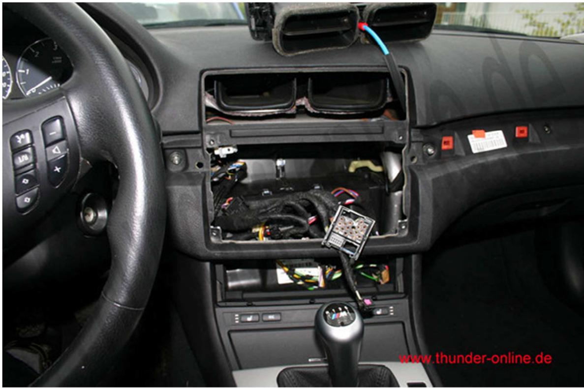
Im nächsten Abschnitt kann man sich dem Funktionsträger und der Schaltkonsole widmen. Zuerst den Schaltsack abziehen, ist eigentlich recht simpel an der Schaltkonsole befestigt. Als nächstes die Konsole abschrauben und die Stecker für die Fensterheber ziehen.
