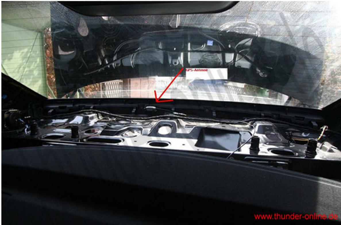
Hier sieht man die "Rechenzentrale" im Kofferraum. Bei einer Total-Nachrüstung werden 2 Blechwinkel als Grundträger benötigt, auf denen sich Komponenten wie Navirechner und Radiomodul oder auch Telefonmodul und CD-Wechsler modular aufbauen. Zusätzlich wird ein neues Teppich-Seitenverkleidungsteil benötigt.
